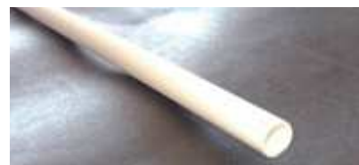
用于人造血管的管状纤维集合 (由 MECC 制造)
