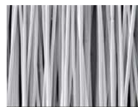
用于支架培养细胞的定向纳米纤维膜
