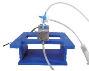
齿轮泵 NW 和 NF-1001 的齿轮泵， 可连续供应溶液
