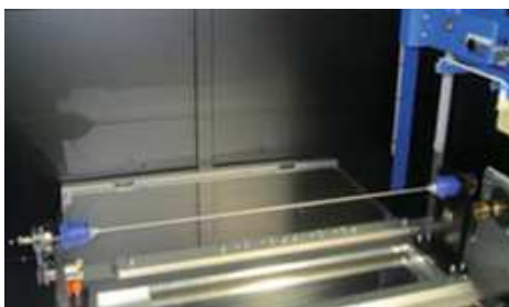
用个性化设计的心轴收集器来静电纺丝构成人工血管的纤维
